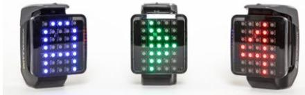
反応を伴うアジリティテストや方向転換走を測定するための信号表示機能を持つセンサーです。光電管と組み合わせて使用する以外に、WITTY-SEM単体で使用することもできます。
